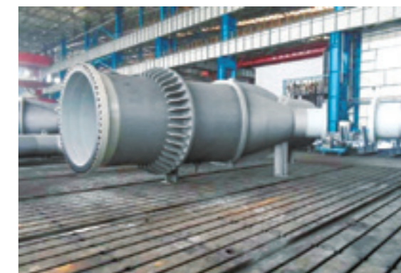
鞍钢 ADB610D 钢板应用在厄瓜多尔水电工程
